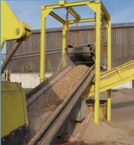
Der JENZ NZ 1600 bereitet vorgebrochenes und gesiebtes Altholz so auf, dass es sich für die Spanplattenproduktion eignet.
